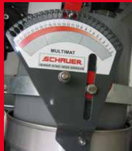
Ajustement progressif de la ration avec 24 positions pour une utilisation simple
